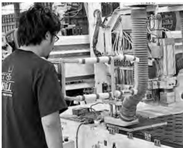
新設備の導入により、ボーリング工程で手作業での調整が不要になったのはもちろん、加工のスピードが上がったことで生産性が向上しました。月あたりの生産高は導入前と比較して30%増加し、お客様のニーズに応える体制が整いました。また、お客様から求められていた接合部の高強度化・接合の位置精度の向上を達成することができました。高い精度の家具を生産し続けることで返品率の低下を実現していきます。
