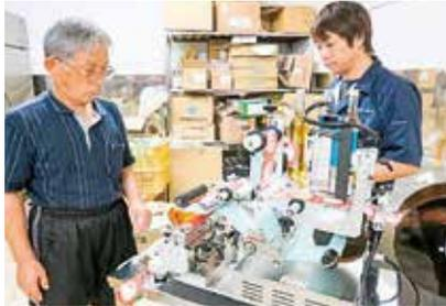
柑橘ジュースのサイズは720mlの1種類で、キャップはすべて王冠型。手作業で行うキャップの取り付けは効率が悪く、「容器(瓶)のバリエーションを増やして欲しい」、「購入後すぐに飲めるように王冠以外の栓にしてほしい」という販売先からのニーズに応えられませんでした。キャッパー設備を導入すれば作業効率は改善され、様々な種類の瓶にも対応できることから、新規販路の開拓が期待できます。
