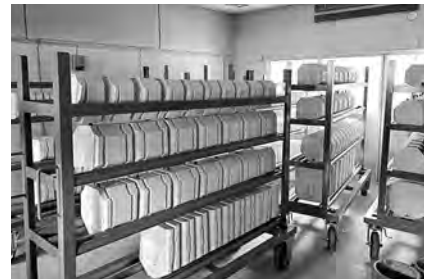
石膏型を搬入する台車(乾燥室内)
